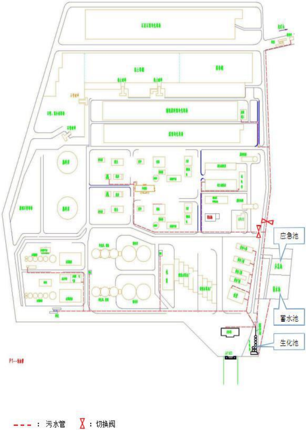
附图 3 雨污管网及切换阀位置图
